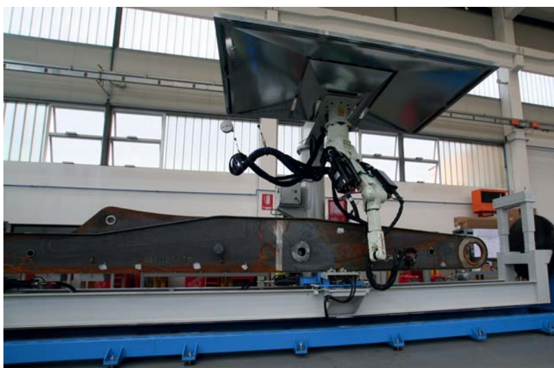
Spawanie ramion pompy do betonu realizowane z robotem Kawasaki
